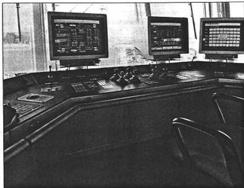
Fig. 5. De baggerlessenaar aan de achterzijde van het stuurhuis (foto: IHC).
